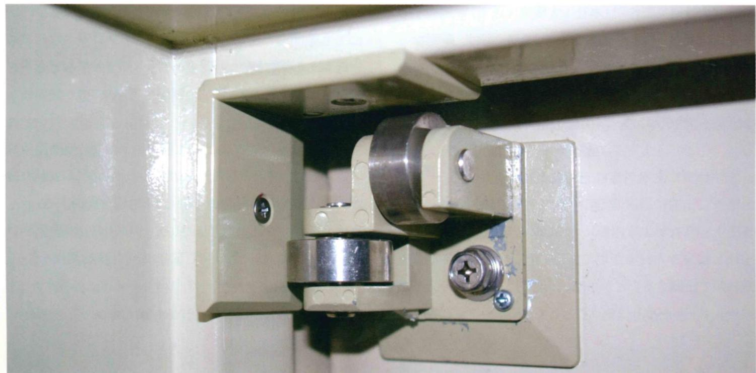
防災用品等を扱う奈良建設株式会社100%子会社の株式会社セットアップ横浜(本社:神奈川県横浜市)が販売する「デレル8」は、地震が起きた時に建物のゆがみでドア枠が変形しても、小さな力でドアを開閉する補助となる商品。2つの金属製ローラーがドア枠とドア扉の接触部分を転がり、接触抵抗を和らげている。
